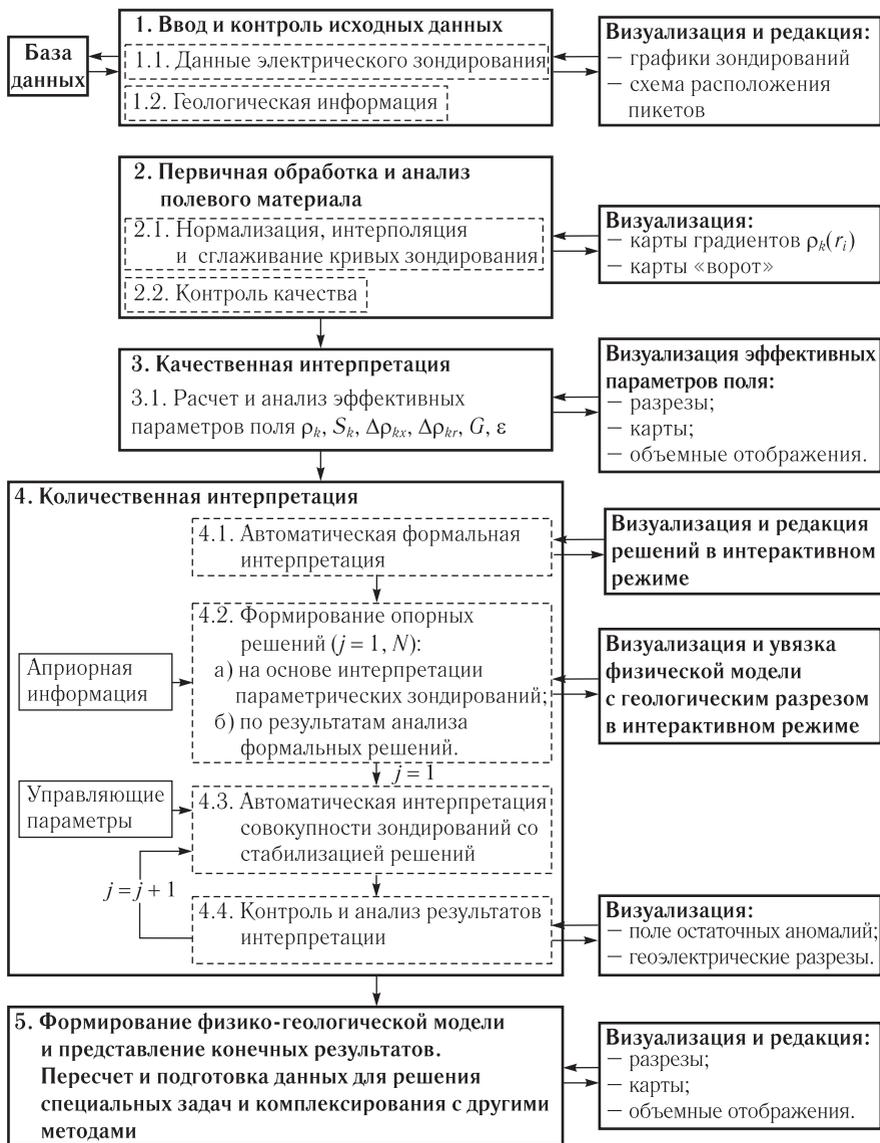
Рис. 3.1. Технологическая схема обработки и интерпретации электрических зондирований с помощью автоматизированной системы ЗОНД
