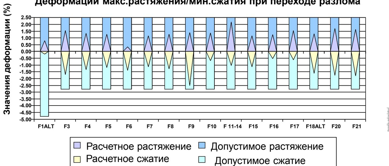
Было установлено, что трубопроводы сохраняют герметичность при полуторном превышении величины расчетной подвижки.
